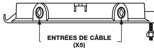
FIGURE 10 : DÉTAILS DU CAPOT DE PLAFOND
