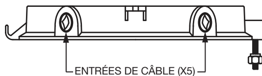
FIGURE 10 : DÉTAILS DU CAPOT DE PLAFOND
